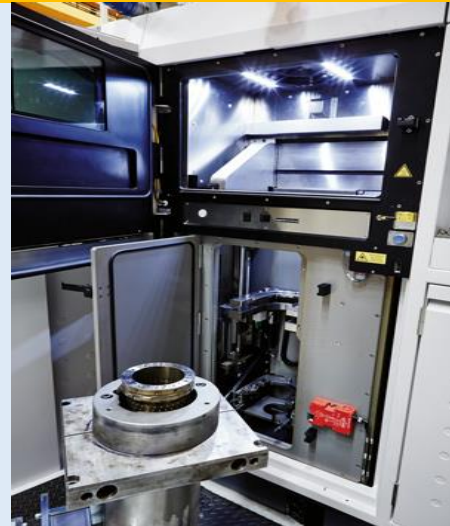
Une pointe de brûleur émergeant de la réparation en 3D Crédit : Siemens
