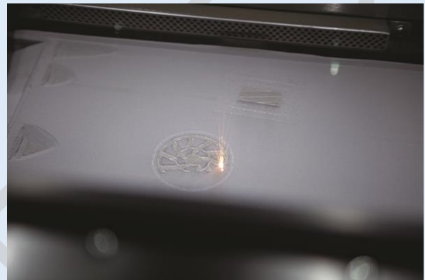
2. Impression 3-D avec du métal. La fusion sélective par laser (SLM) et la fusion directe par laser métallique (DMLM) utilisent des lasers pour faire fondre une poudre métallique une couche à la fois, pour créer des composants complexes de turbines à gaz. Courtoisie : GE Oil & Gas
