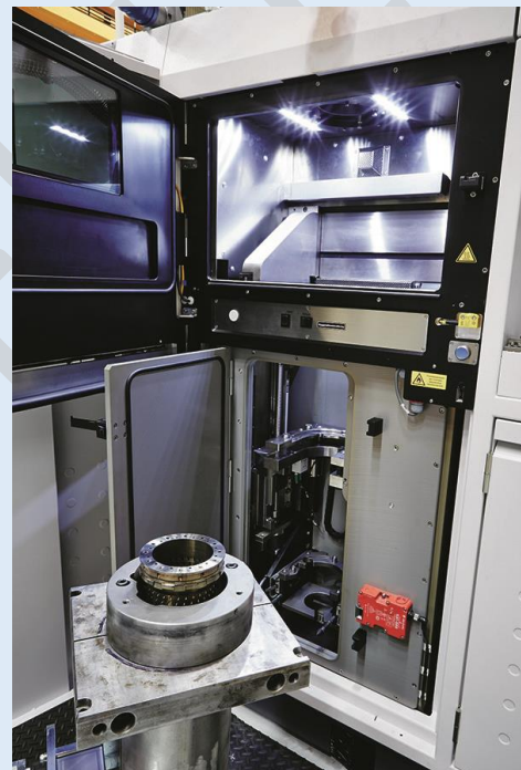
3. Réparation rapide. À l'aide de la fabrication d'additifs, Siemens peut réparer les pointes du brûleur 60% plus rapidement que les méthodes traditionnelles. Courtoisie : Siemens
