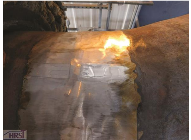
2. Prêt pour les tests. Une préparation correcte de la surface est essentielle pour effectuer des évaluations non destructives. Gracieuseté de HRST Inc.
