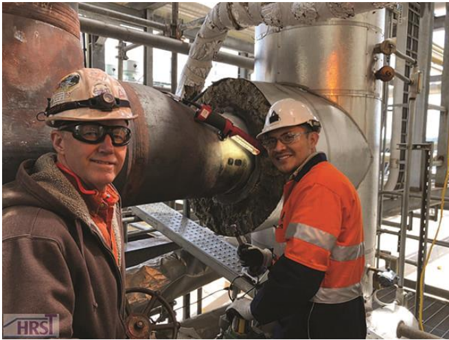
1. Identification matérielle positive. Les travailleurs sont montrés ici en train de préparer une soudure pour obtenir des lectures de réplication et de dureté. Gracieuseté de HRST Inc.
