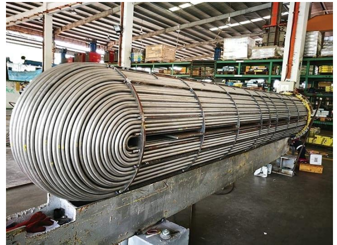
1. Un faisceau de tubes en U est montré ici en cours de fabrication dans un atelier mécanique. Source: Shutterstock
